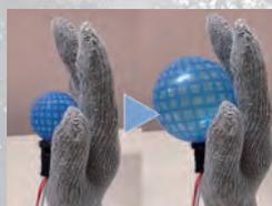
落ちモノゲーム「Catch 実 if you can」は力触覚提示を利用したVRゲームです。プレイヤーはHMDを頭に装着し、手袋型の触覚提示デバイス「パームズ」を手にはめ、VR空間に現れる「実」を手で掴んで並べていきます。プレイヤーが実を掴むと、パームズ内に空気が送り込まれ掌の前で空気圧バルーンが膨らむことで指の動きが制限され、手に何かを掴んでいるという感覚が提示されます。
