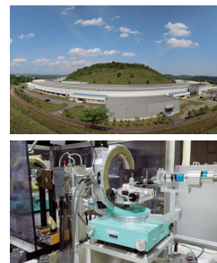
(左) 研究対象としての銅酸化物高温超伝導体の結晶構造。(右上) 大型放射光施設「SPring-8」(提供: JASRI)。(右下) 関学内実験室に設置されている単結晶構造解析用4軸回折計。
