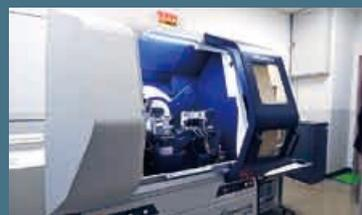
試料水平型X線回折装置
