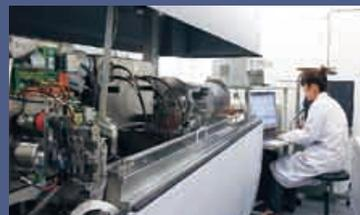
飛行時間型質量分析装置 (TOF-MS/MS)
