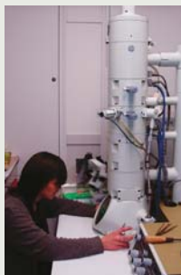
透過型電子顕微鏡 電子線を用いた顕微鏡で20万倍の高倍率で観察することができます。また、ミクロン単位の薄い切片を作る装置も付属しています。
