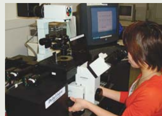
セクション蛍光顕微鏡システム 計算処理より鮮明な3D蛍光画像を構築する装置で、立体カラー表示や動画表示などができます。
