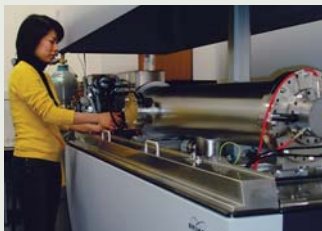
飛行時間型質量分析装置 (TOF-MS/MS) 細胞で機能している特定のタンパク質を見つけたり(プロテオーム解析)、タンパク質の修飾を瞬時に解析できる装置です。
