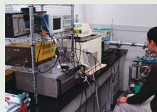
時間分解蛍光共鳴エネルギー移動測定装置 蛍光共鳴エネルギー移動(FRET)現象を利用し、タンパク質間相互作用の変化を測定します。
