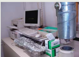
高周波プラズマ発光分析装置 環境水から培地まで、あらゆる水溶液に含まれる元素をアルゴンプラズマによって励起して分析します。
