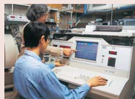
多重周波数EPRスペクトロメータ 物質や生体中の電子がもつ磁気モーメントの電磁波エネルギーの吸収を多くの周波数で観測します。
