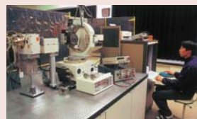
薄膜構造解析用 高分解能型X線回折装置 LSIやメモリーの基幹部分の表面・界面構造をナノメートルスケールで調査・決定します。
