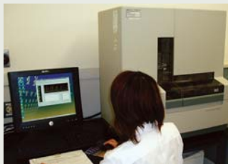
DNAシーケンサー 遺伝子などの塩基配列を蛍光標識とガラスキャピラリーを用いて、同時に4種解析できる装置です。
