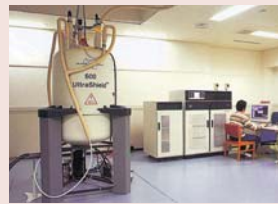
超伝導核磁気共鳴(NMR)装置 DNAやタンパク質など生体中の巨大分子が水溶液中で構造変化していく様子を原子レベルの分解能で観測するために、多次元NMRスペクトルを測定します。
