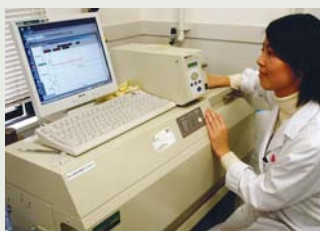
円偏光二色性分析装置 タンパク質分子のもつ円偏光二色性を利用して溶液中での立体構造を解析することができます。
