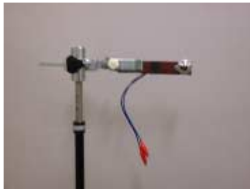
図 3 - 23 撮影用光源 (スライダックで明るさを調節)
