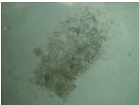
図 2 - 18 粉々になったラパート滴 (オランダの涙)。 細い部分を折っただけで全体が粉々になる。
