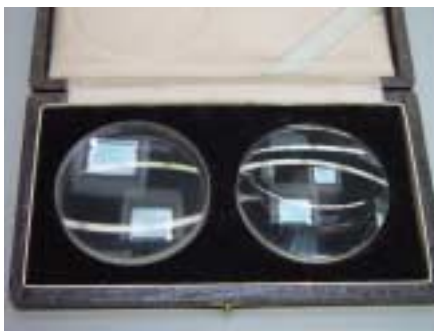
図 5-38 2枚の屈折率の異なる材質のレンズの組み合わせによる色消レンズ
