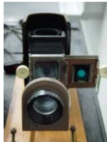
図 5-5 光源フィルター部分詳細
