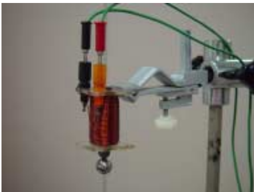
図 1 - 30 鉄球 (サル) 保持の電磁石
