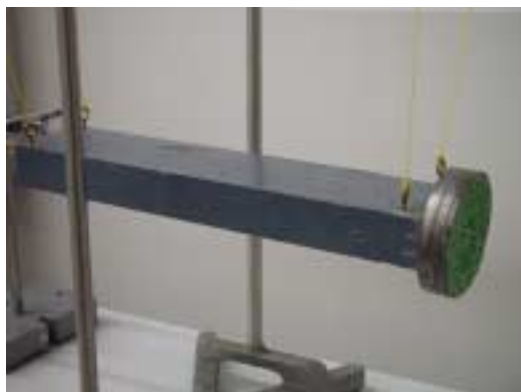
図 1 - 21 弾丸受け取り用振り子部分
