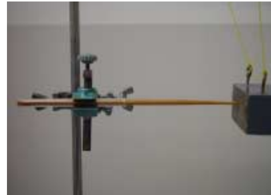
図 1 - 22 振り子の移動距離測定部分 振り子の端に竹の棒が接するようにセットする。
