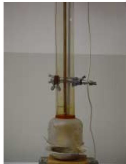
図4-21 コットレルの集塵装置
