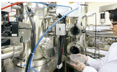
炭素原子一層分の厚みをもつシート(グラフェン)をつくると、その中を電子は非常に高速で走ります。このような原子レベルで制御された魅力的な物質をどのようにつくるのか？ 研究室では、2000℃を超える超高温、さらに超高真空という独自の環境を開発し、その中で原子が自発的に動いてさまざまな結晶の配列に発展する現象の解明と制御をめざしています。
