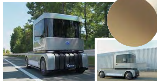
(上と右下) 水加ヒドラジンによる燃料電池搭載のダイハツ「FC凸DECK」は田中教授渾身の一台。(右上) 自己再生機能を持つ「インテリジェント触媒」はナノテクノロジーの結晶。
