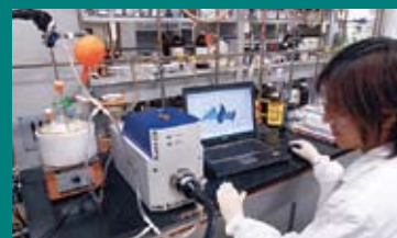
フロー式分光計 (React IR) 反応溶液の中で起きている分子の挙動の変化について、赤外スペクトルによって解析することができる装置。有用有機反応の開発などに活用されている。
