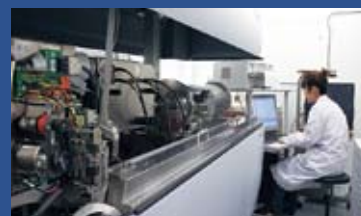
飛行時間型質量分析装置 (TOF-MS/MS) 細胞の中で機能している特定のタンパク質を見つける「プロテオーム解析」を行ったり、タンパク質の翻訳後修飾を瞬時に解析できる装置。
