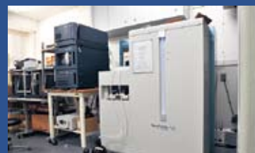
液体クロマトグラフィー / 質量分析装置 (LC/MS) 有機化学物質を精密に測定するための、優れた分離能、検出感度、同定能力を有する分析装置。熱に不安定な化合物や難揮発性化合物などの構造解析が可能。
