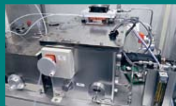
遠紫外分光器 遠紫外分光法を用いて水・水溶液の微量成分を測定できる装置。尾崎研究室と企業が共同開発した独自のもので、世界で初めて水のスペクトルの測定に成功した。
