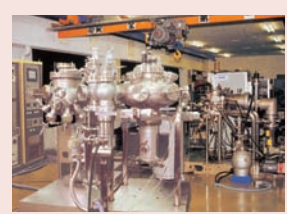
高性能分子線エピタキシー装置 原子一個厚さの半導体薄膜を超高真空下で自由に蒸着・剥離します。
