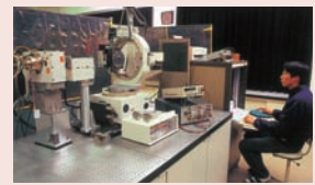
薄膜構造解析用 高分解能型X線回折装置 LSIやメモリーの基幹部分の表面・界面構造をナノメートルスケールで調査・決定します。
